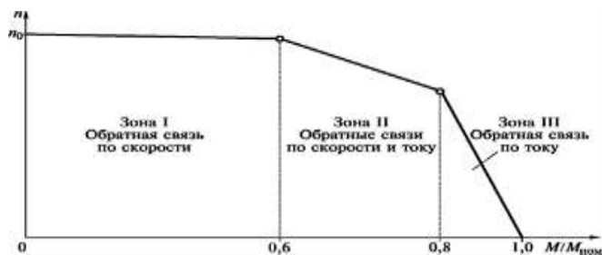
Сурет. 11.6. Жүктеме жылдамдығы мен ток кернеген кері байланысымен электр жетегінің үш аймақтық механикалық сипаттамасы
