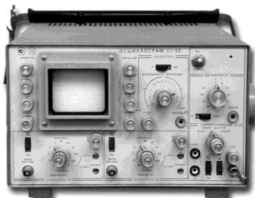
5.16 сурет. Қоссәулемлі осциллографтың сыртқы көрінісі
