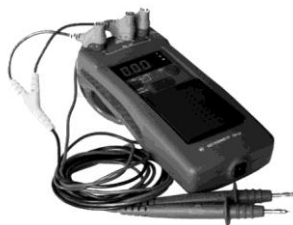
5.12 сурет. Заманауи мегомметрдің сыртқы бейнесі
