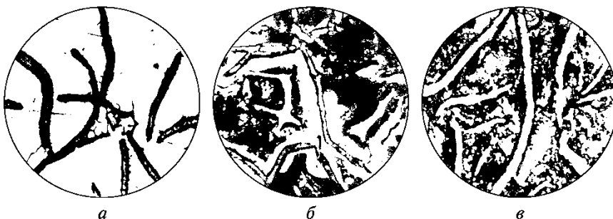
Сурет 4.12. Ферритті (а), феррит-перлитті (б) және перлитті (в) негізде сұр шойынның микроқұрылымы, 200есе ұлғайтылған.
