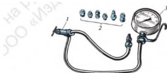
16.1.сурет Отын сорғысын тексеруге арналған НИИАТ-527Б құрылғысы:
