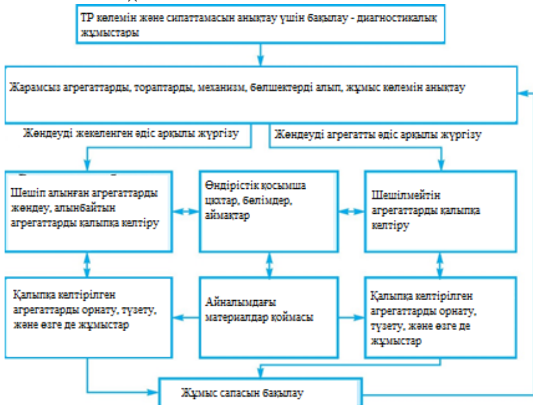
34.1 сурет Көліктерді ағымдық жөндеу процессінің схемасы.
