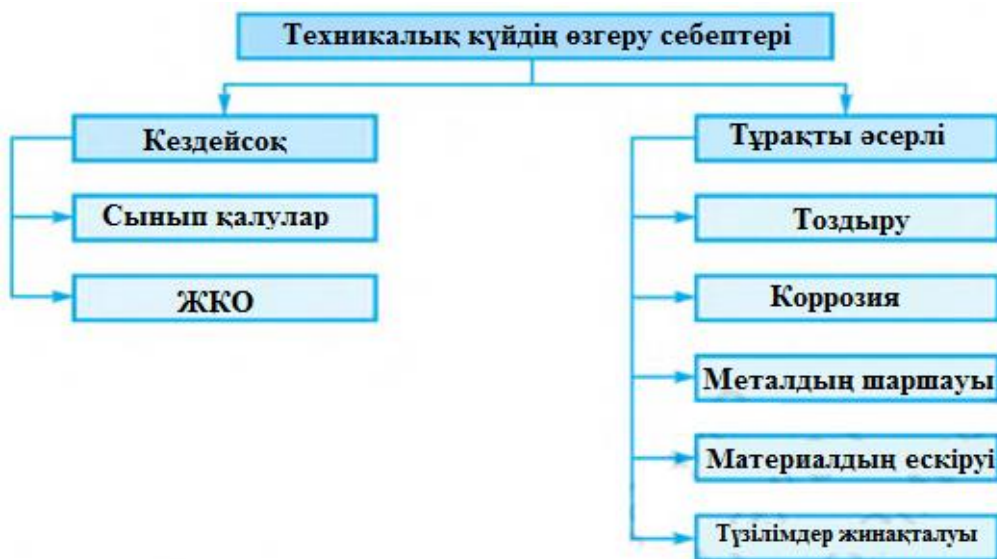
1.2. сурет. Автомобиль элементтерінің техникалық күйінің өзгеру себептерінің жіктемесі
