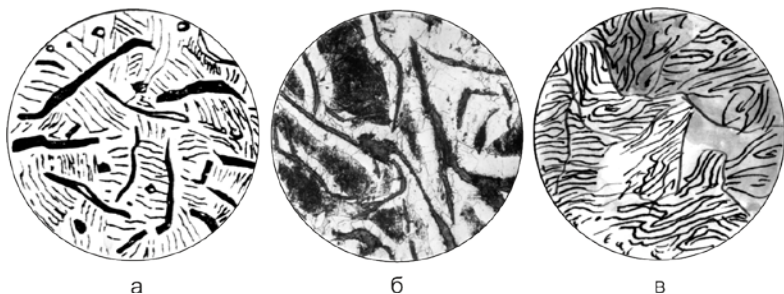
9.2. сурет. Сұр шойынның микроқұрылымы: а — ферриттік; б — феррит-перлиттік; в — перлиттік
