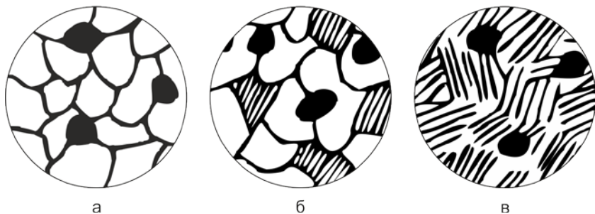
9.3. сурет. Төзімділігі жоғары шойынның микроқұрылымы: а — ферриттік; б — феррит-перлиттік; в — перлиттік
