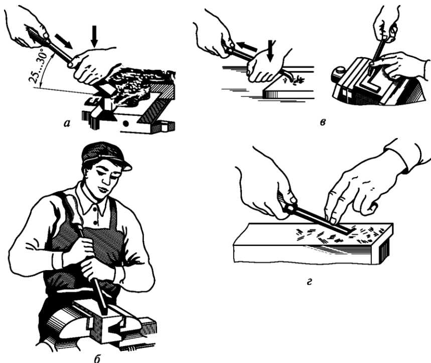
4.35 -сурет. Тегіс бөлшектерді «өзінен» (а) және «өзіне қарай» (б) қыру, жырашықтарды қыру (в), әрлеу операцияларын орындау (г)
