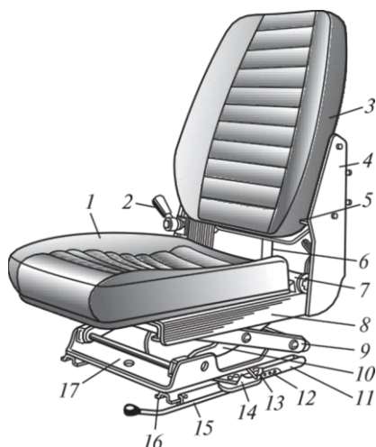
4.120 -сурет. КамАЗ автокөлігі жүргізушісі орындығының құрылғысы:
