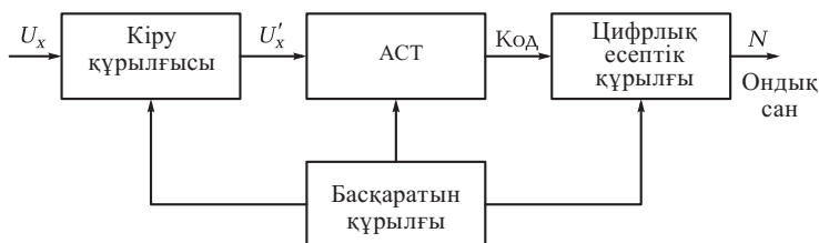
8.15-сурет. Цифрлық вольтметрдің жеңілдетілген құрылымдық схемасы
