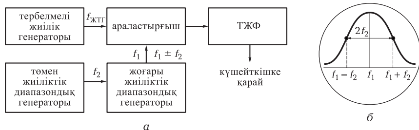
12.7-сурет. Жиіліктерді үш жылжымалы таңбалар арқылы өлшеу: а – белгілердің түзілу схемасы; б – ЭСТ экранындағы бейне
