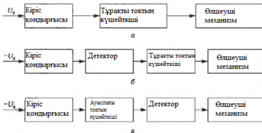
8.6 сурет. Электрондық вольтметрлердің құрылымдық схемалары:
