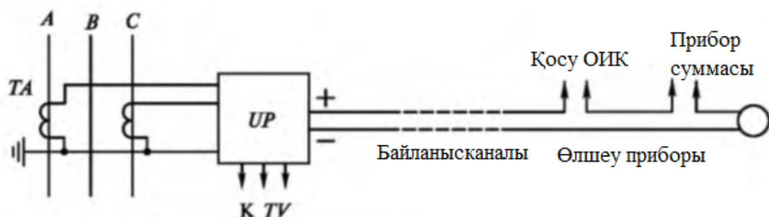
4.54 сур. Алыстан өлшеу құрылғыларының құрылымдық сызбасы
