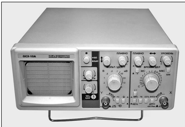
Сур. 5.18. Осциллографтың сыртқы түрі ОСУ-10А
