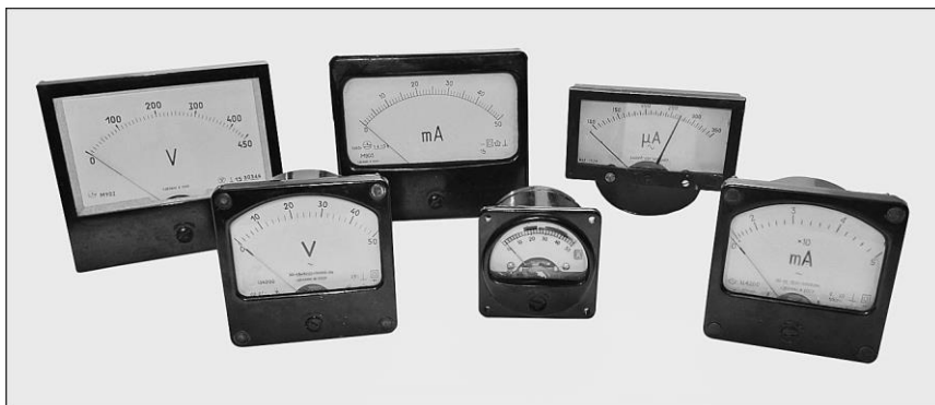
Сурет. 1.13. Электромеханикалық өлшеу құрылғылары
