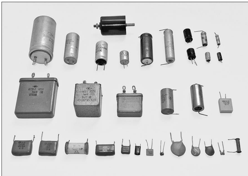
Сур. 6.2. Конденсатордың ең көп таралған түрлерінің сыртқы бейнесі
