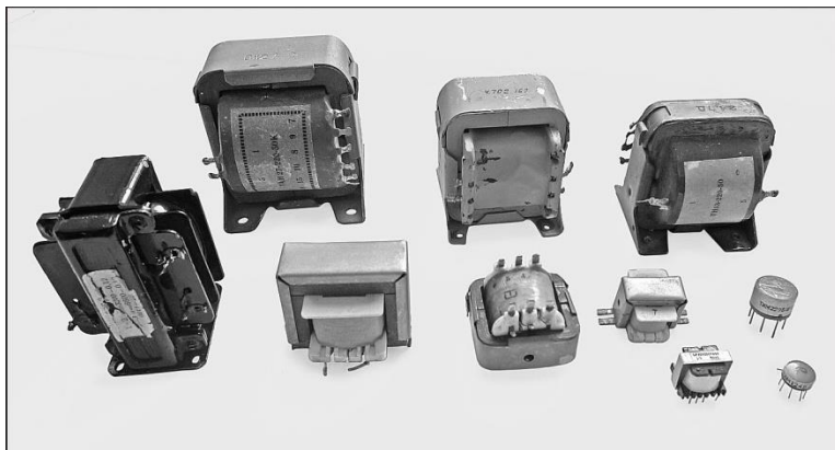
Сур. 7.2. Радиотехникада қолданылатын трансформаторлар
