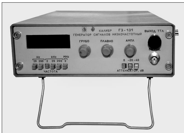
Сур. 5.22. ГЗ-131 генераторының сыртқы түрі
