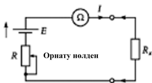
Т.2 -сурет. Ваттметр (а) мен омметрді (б) осылу сызбасы
