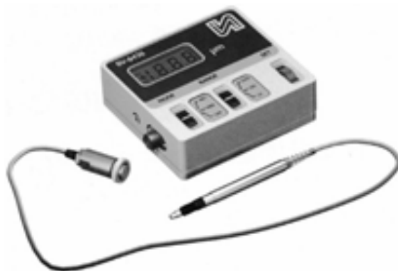
4.20.сурет. Индуктивті түрлендіргішпен тасымалданатын өлшеу жүйесі
