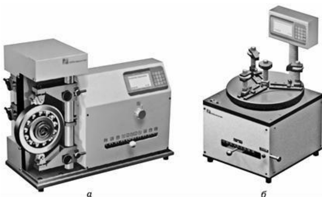
4.19. сурет. Радиалды (а) және осьтік (б) мойынтіректерді бақылауға арналған құрылғылар
