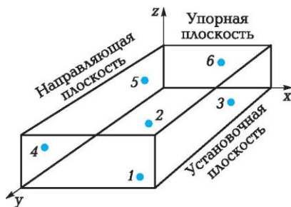
3.5- сур. Призматикалық тікбұрышты қалыптағы үш өлшемді негізгі бөлшектер:
