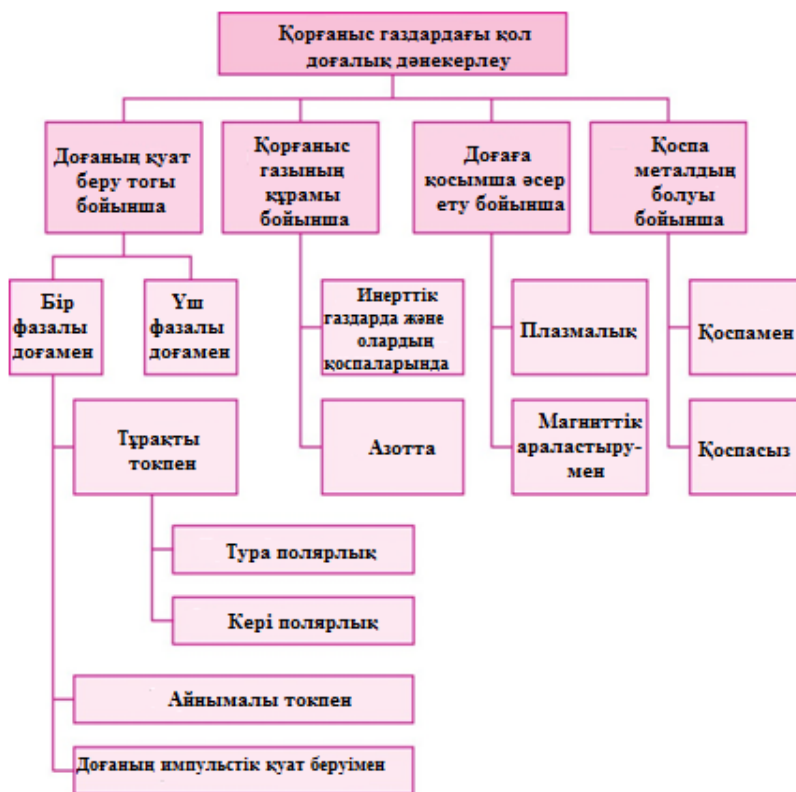
3.2-сурет. Қорғаушы газдарда қолмен доғалық пісірудің негізгі тәсілдерінің топтастырылуы
