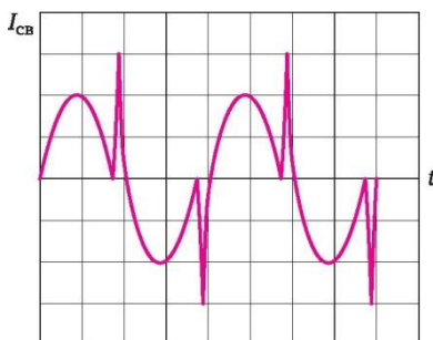
1.28. сурет. Қайтадан тұтану импульстері бар ағымдағы графикті дәнекерлеу
