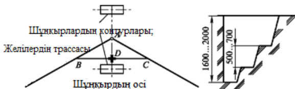
11.8 суреті. Шұңқырды бұрыштық анкерлік тіреу бойымен ажырату (а) және қол әдісімен ашылған шұңқырдың нысаны
