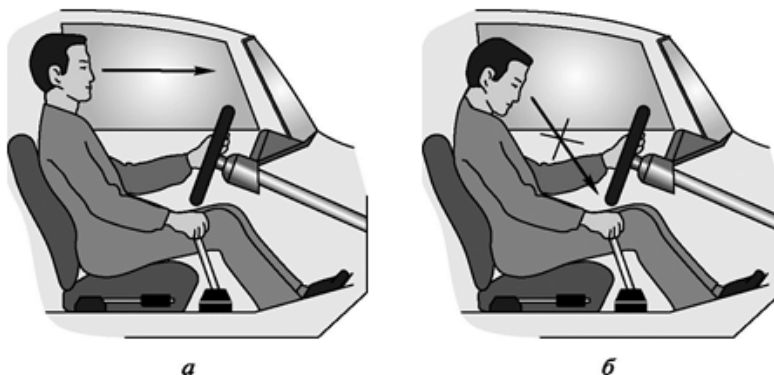
2.4-сурет. Берілісті ауыстырған кезде бағытты қараңыз: a — дұрыс; б — дұрыс емес
