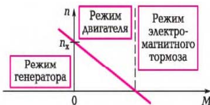
Режим генератора – генератор режимі; режим двигателя – қозғалтқыш режимі; режим электромагнитного тормоза – электромагниттік тежеуіш режимі 9.42-сурет
