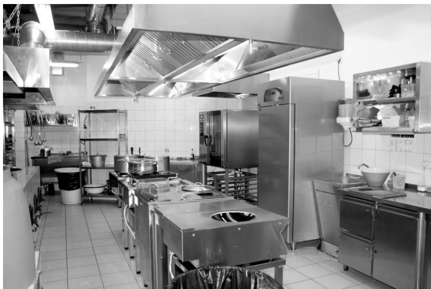
8.2. – сурет. Ыстық цехтың жылыту тізбесі, тұздық бөлімі. (пастакукер, секциялық құрылғы, электр плита, пароконвектомат)
