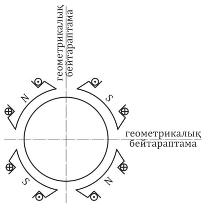
1.9.-сурет. Төрт полюсті тұрақты ток машинасының сұлбасы
