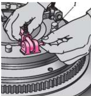
6.11-сур. Ажыратқышты сөндіру тетіктерін бөлшектеу:
