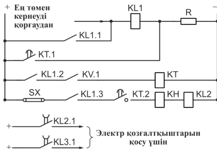
10.4. сурет. 6 немесе 10 кВа кернеуі бар АҚҚ электр қозғалтқыштары қондырғысының қағидалық сызбасы
