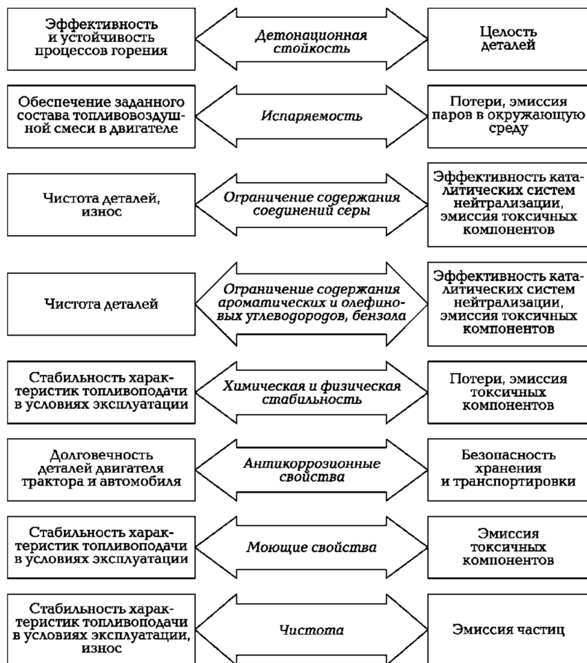
3.1 сурет. Автокөлік бензинін пайдалану қасиеттері, оларды пайдаланудың тиімділігі мен қауіпсіздігін қамтамасыз етеді
