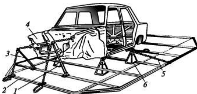
25.3-сурет. Жеңіл автокөлік шанағын түзетуге арналған стенд: 1, 3 — жұмыс цилиндрлері; 2 — рама; 4 — шанақ; 5 — керу құралы; 6 — үйкегіш
