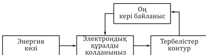
Сурет. 7.12. Автогенератордың блок-схемасы
