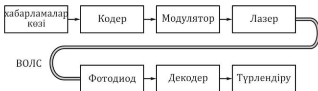
Сурет. 11.11. Талшықты-оптикалық байланыспен оптикалық байланыс желісі
