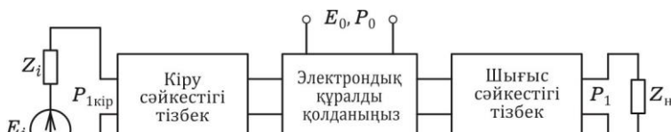
Сурет. 7.8. Сыртқы қозғаумен генератордың функционалдық схемасы
