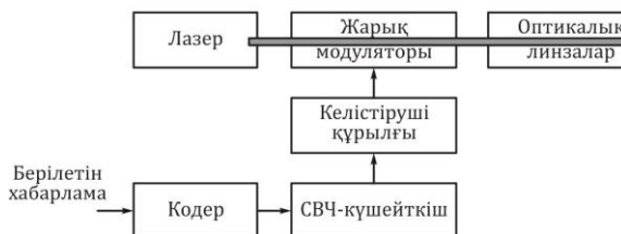
Сурет. 11.3. Оптикалық таратқыштың құрылымдық диаграммасы
