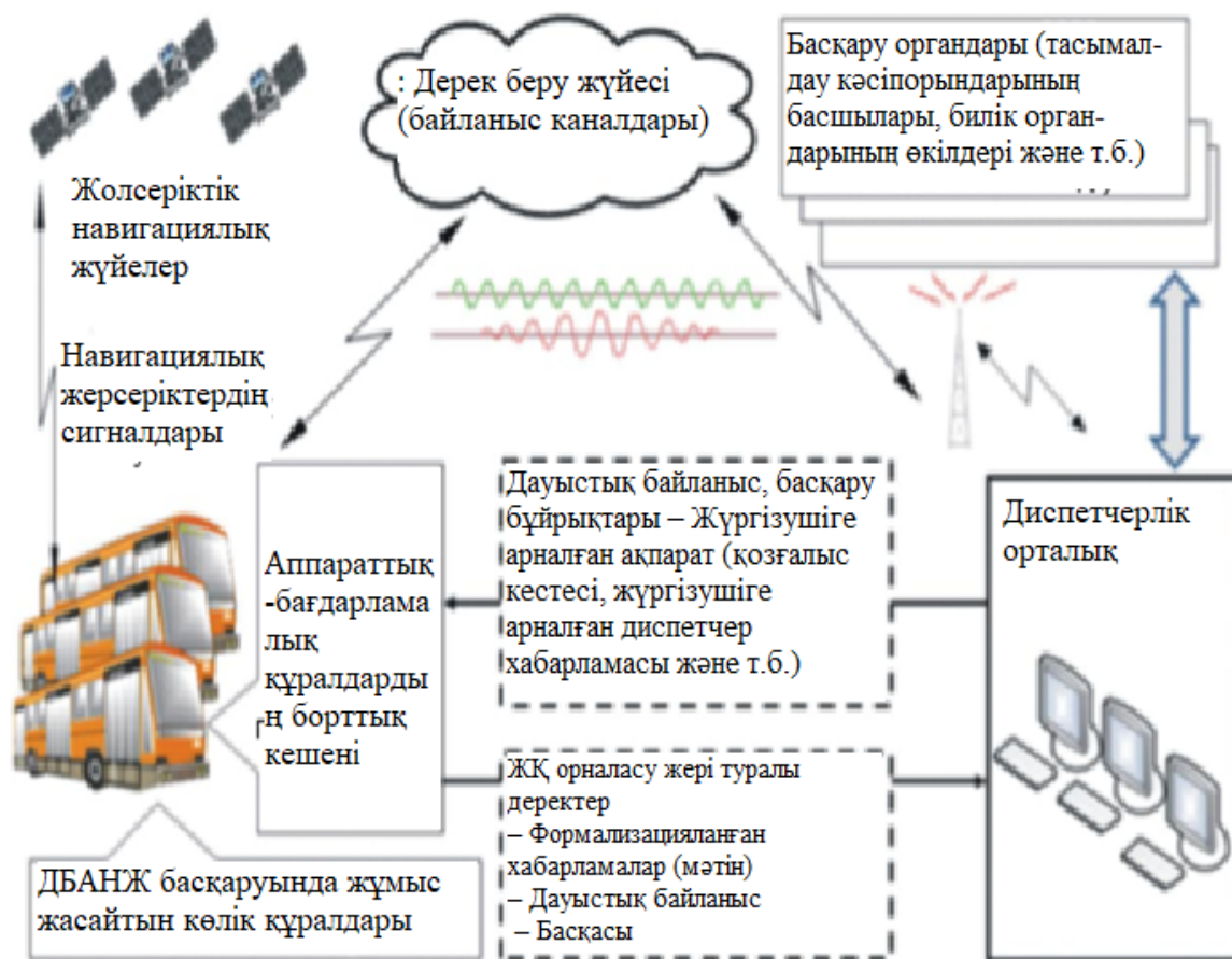
3.22 сур. – Жолаушылар тасымалын спутниктік навигация негізінде ДБАНЖ жұмысының схемалық сызбасы
