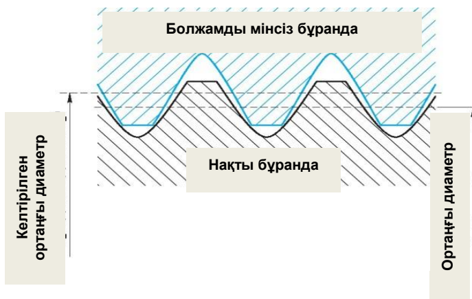
4.29-сурет. Бұранданың келтірілген ортаңғы диаметрі
