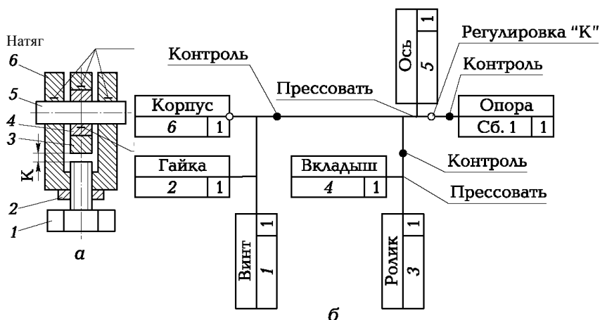
7.3-сурет. «Тірек» (а) өнімінің құрастырма сызбасы және (б) схемасы
