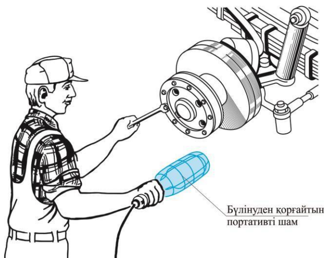
2.16 -сурет. Механикалық бүлінуден қорғайтын портативті шам
