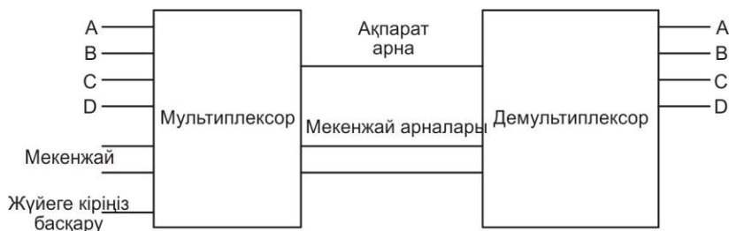
13.15-сурет. Мультиплексорды және демultipлексорды пайдаланушы басқару жүйесінің схемасы
