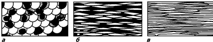
2.30-сурет. Металдың пластикалық өзгеруі кезінде құрылымның өзгерістері:
