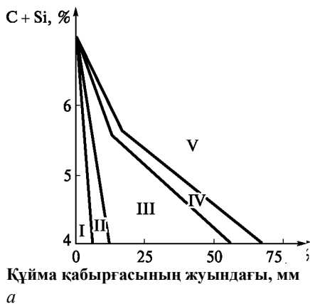
7.1-сурет. Шойындардың құрылымдық диаграммасы:
